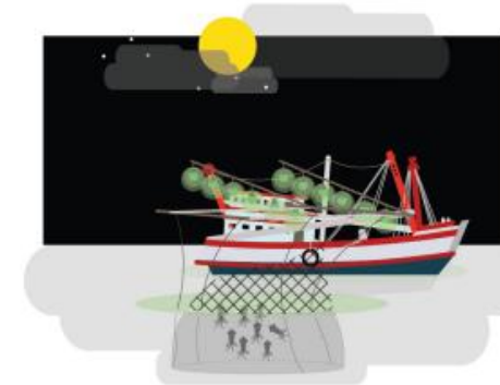
อวนครอบ อวนช้อน หรืออวนยกหมึก ที่ใช้ประกอบเครื่องปั่นไฟ
